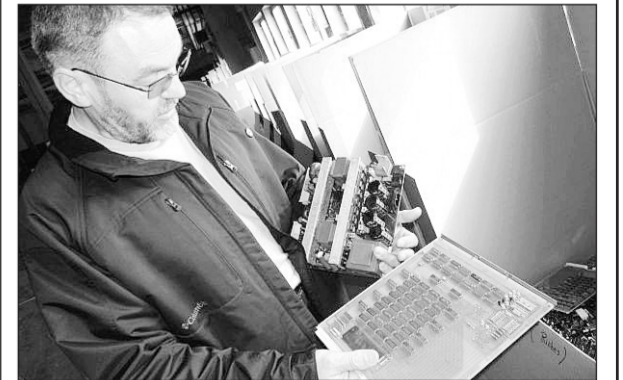
Michel Robin montre des composants de centraux téléphoniques, en grande partie recyclables
